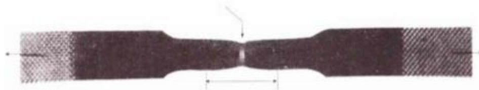
Gambar 1.11 Necking pada batang baja lunak yang mengalami Tarik
