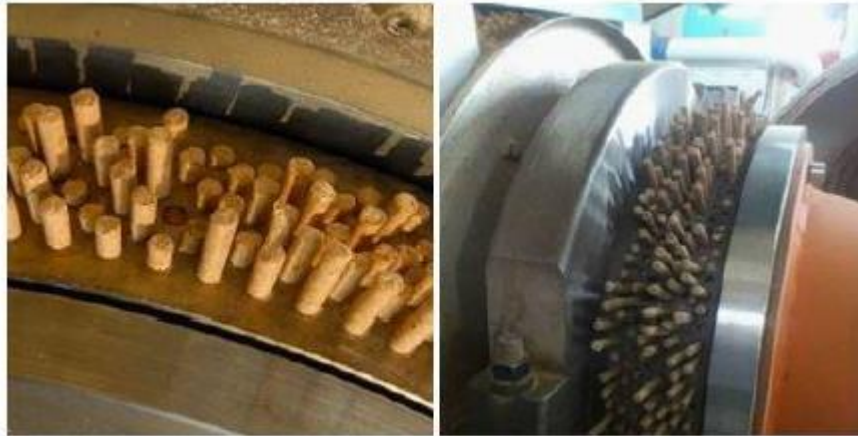
Gambar 3.21 Proses Terbentuknya Formasi Pellet Kayu/Pellet Energi Pada Pelletiser Jenis Ring Die
