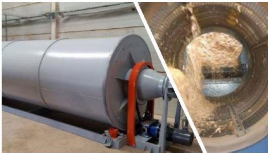
Gambar 3.19 Drum Dryer Yang Banyak Digunakan Pada Proses Pengeringan Serpih ( Chip ) Maupun Serbuk Kayu Pada Industri Pellet Kayu/Pellet Energi (Sumber: Amirta, 2018)
