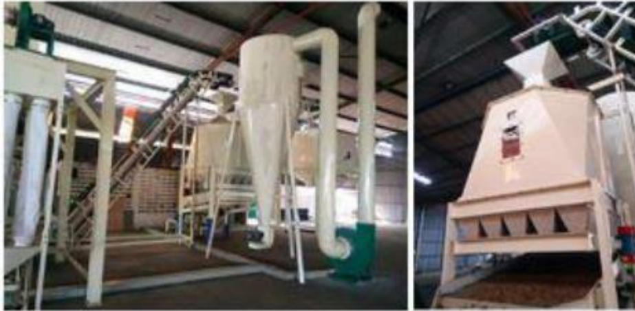
Gambar 3.23 Menara Pendingin ( Cooling Tower ) Pada Industri Pellet Kayu/Pellet Energi (Sumber: Amirta, 2018)
