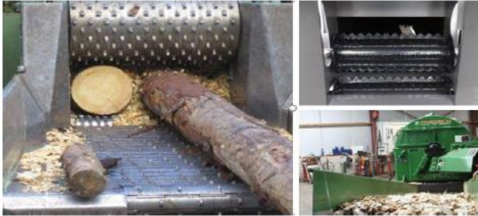
Gambar 3.17 Wood Chipper Bertenaga Besar Yang Mampu Mencacah Log Menjadi Serpih Kayu (Sumber: Amirta, 2018)
