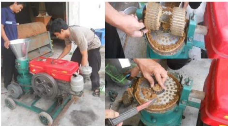
Gambar 3.22 Pelletiser Atau Alat Pencetak Pellet Kayu Sederhana Dengan Penggerak Diesel (Sumber: Amirta et al, 2018)
