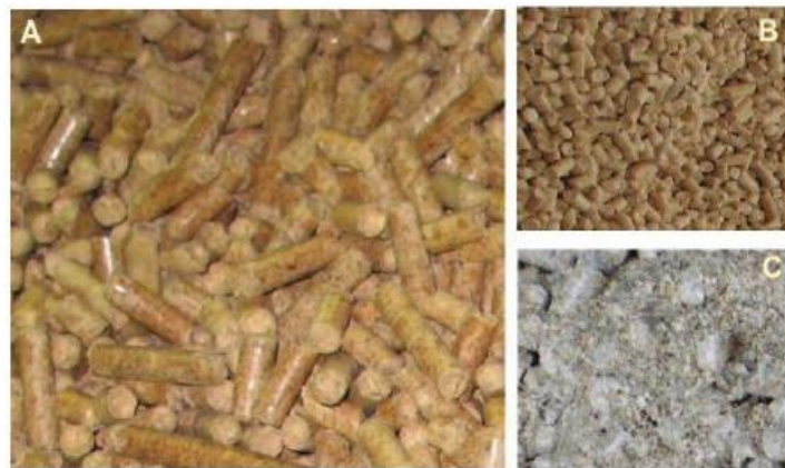
Gambar 3.27 Perbandingan kualitas pellet kayu didasarkan pada kekuatan struktur mekanisnya: A. pellet dengan kualitas yang baik; B. pellet dengan kualitas sedang dan C. pellet kayu kualitas rendah, struktur pellet hancur menjadi remah
