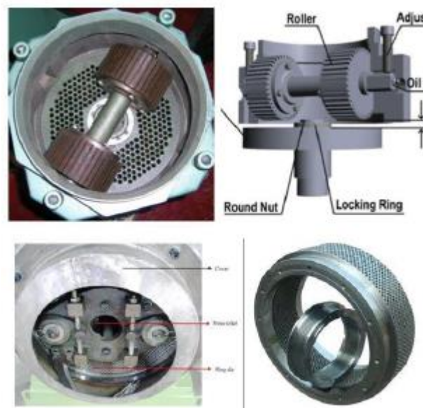
Gambar 3.20 Jenis Alat Cetak/Kempa Pada Industri Pellet Kayu ( Die ): Flat Die (Atas) Dan Ring Die (Bawah)
